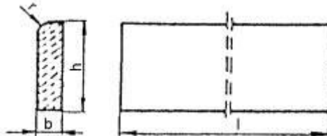
Rysunek 1. Kształt betonowego obrzeża chodnikowego
